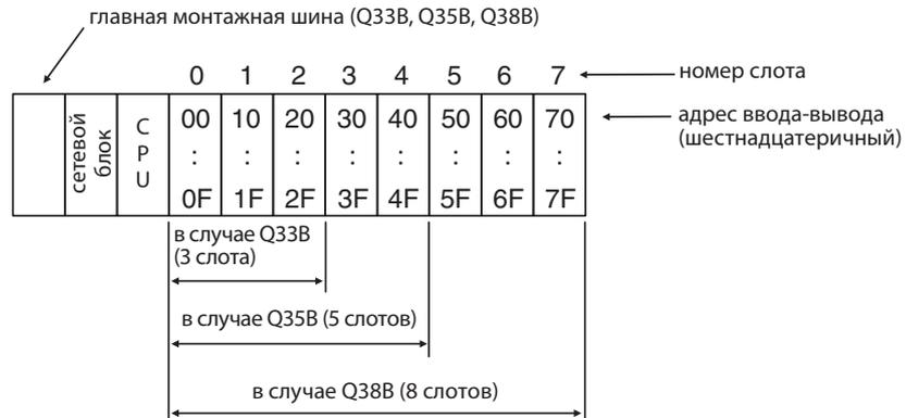
При присвоении адресов ввода-вывода система предполагает, что на всех слотах установлены модули с 16 входами или выходами. Поэтому от слота к слоту адреса ввода-вывода повышаются на 16 (от 0 до F в шестнадцатеричном счислении). Если, однако, в слот вставлен модуль с 32 входами или выходами (на следующей иллюстрации это слот 5), это учитывается и адреса последующих слотов соответственно смещаются.
