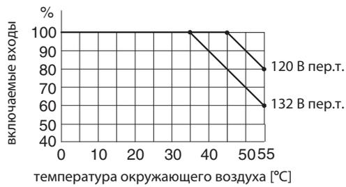
Максимальное количество одновременно включаемых входов модуля QX10 зависит от температуры окружающего воздуха.
